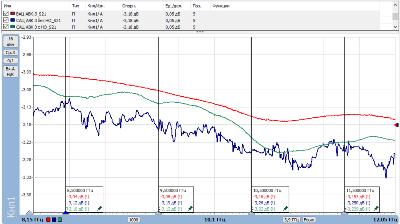
Рисунок 16. Сравнение измерений модулей коэффициентов передачи различных схем с аттенуатором 3 дБ.
