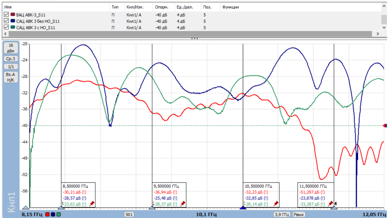
Рисунок 14. Сравнение измерений модулей коэффициентов отражения различных схем с аттенуатором 3 дБ.
