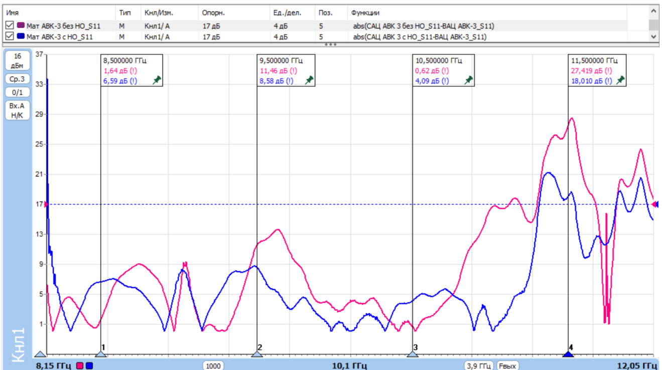
Рисунок 15. Сравнение воспроизводимости измерений модулей коэффициентов отражения различных схем с аттенуатором 3 дБ.
